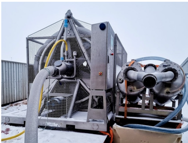
Mynd 3: Dælnar sem notaðar voru við tilraunir, ValuePump til vinstri og vakúmdælan til hægri
