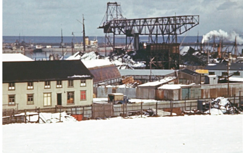
Hegrinn við höfnina, öðru nafni kolakraninn, hífði kol úr skipum og losaði í bing í portinu. Kolin voru m.a. seld til upphitunar húsa. Gufuskipin þurftu kol til að brenna. Kyndarar um borð höfðu þann starfa að moka kolum í brennsluofna gufuvelanna. Þar var ansi heitt.
