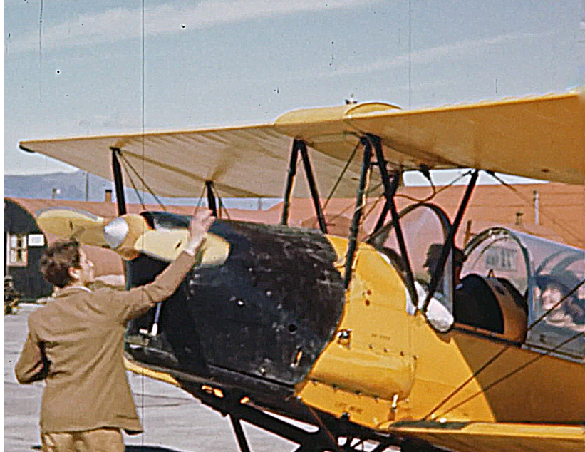
Það þurfti að snúa skrudfunni með handafla til að koma þessari gömlu tvíþekju í gang. Flugskólarnir buðu upp á hringflug yfir Reykjavík.
