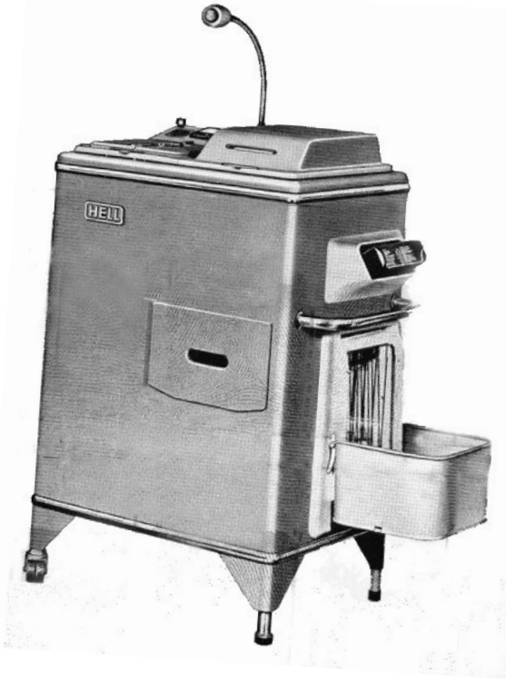
Móttökutæki fyrir símamyndir, sem Sjónvarpið eignaðist og sett var upp á fréttastofunni. Reyndist hið mesta þarfabing. Hljóðneminn var notaður fyrir samtöl okkar við London þegar tekið var á móti myndum. Framan á tækinu ofarlega var hylki með ljósnæmum pappír. Myndirnar voru framkallaðar í tækinu og komu fullbúnar í boxið að framan.
