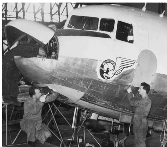
Í aðalflugskýlinu var unnið nótt sem nýtan dag. Milli ferða voru flugvélar teknar í eftirlit en í stórskoðunum voru þær nánast tættar í sundur. Öryggið fyrir öllu.
