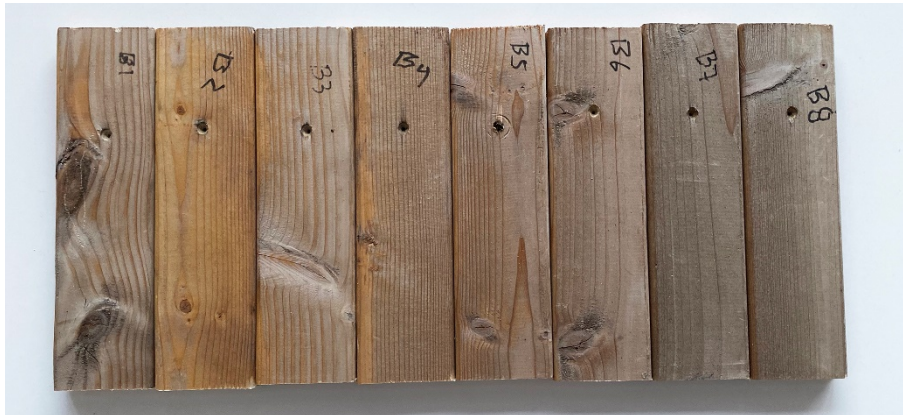
Mynd 5: Tréborð með blöndunum átta, eftir 7 mánaða veðrun
