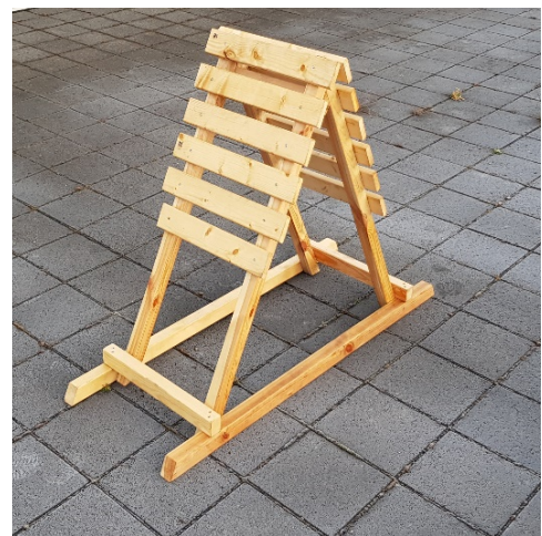
Mynd 1: Tilraunaburst – Tréborðum komið fyrir á burst með viðarvörn
