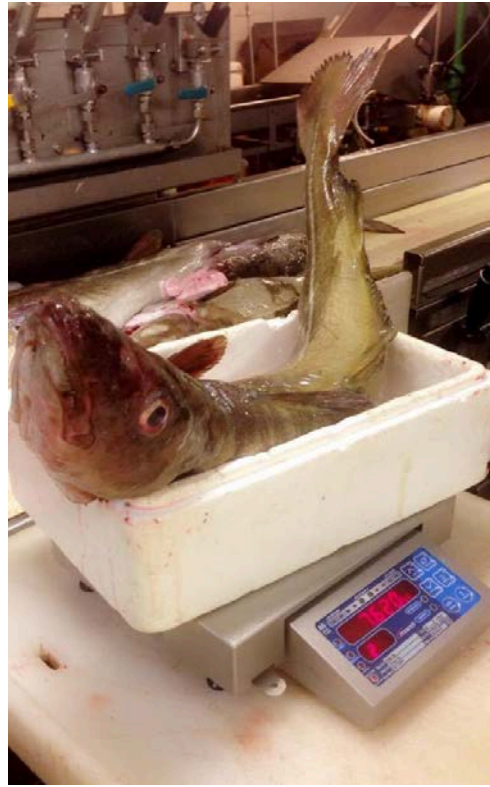
Mynd 1. Þorskur lengdarmældur og vigtaður fyrir slægingu á M1100 vog frá Marel.
