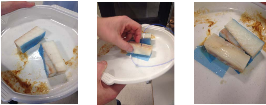
Mynd 28. Bitar fyrirþíðingu (vinstra megin), staðsetning hitanema (í miðju), bitar eftir þíðingu (hægra megin).
