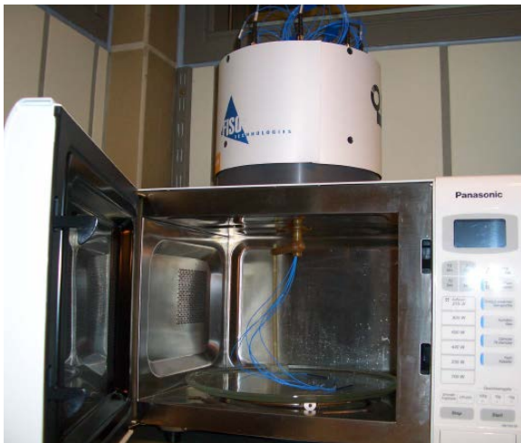
Mynd 18. Örbylgjuofn með hitanemum og hugbúnaði til stýringar (Panasonic NN-T251 W, Panasonic CS UK, Berks UK).
