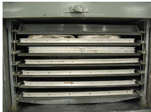
Mynd 12. Þíðing í umbreyttum plötufrysti.
