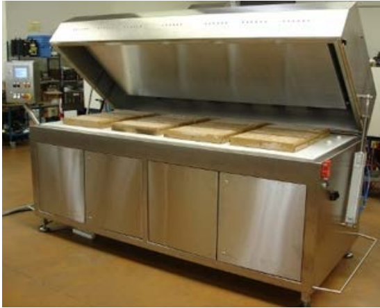
Mynd 14. Sairem RF 900 búnaður til þíðingar með útvarpsbylgjum.
