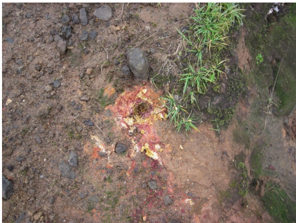
Mynd 12. Sýni 1029 Ic var tekið af jarðvegi úr hitaskellu. Hitastigið var 27,4°C og pH5.
