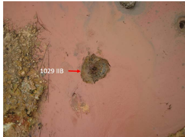
Mynd 14. Sýni 1029 IIB fyrir og eftir sýnatöku. Sýnið var tekið af rauðleitum leir úr opnu. Hitastigið var 96°C og pH 5.
