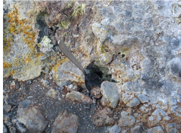
Mynd 151. Sýni 1100 var þurr jarðvegssýni tekið af sandi, mól og gulleitum útfellunum úr þessu gufuauga. Hitastigið var 65°C og pH 5,6.
