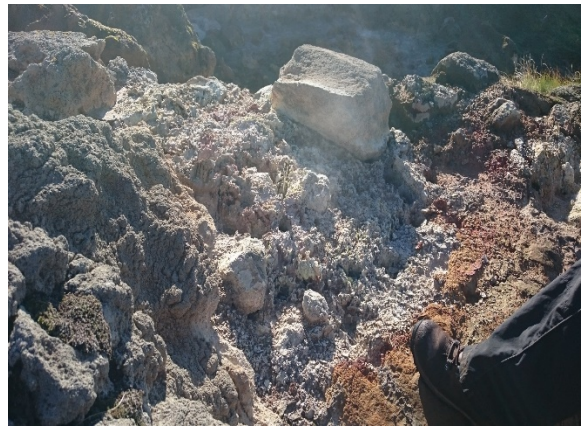
Mynd 101. Sýni 1057 var jarðvegssýni tekið úr brennisteinsþúfu 2m neðar en 1055. Hitastigið var 70,6°C pH 2,5.
