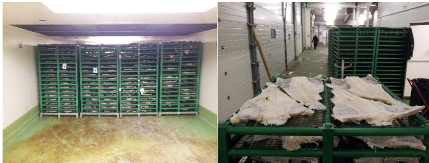
Mynd 8. Stæðum raðað í þurrklefa, ásamt staðsetningu saltfisks á grindur.
