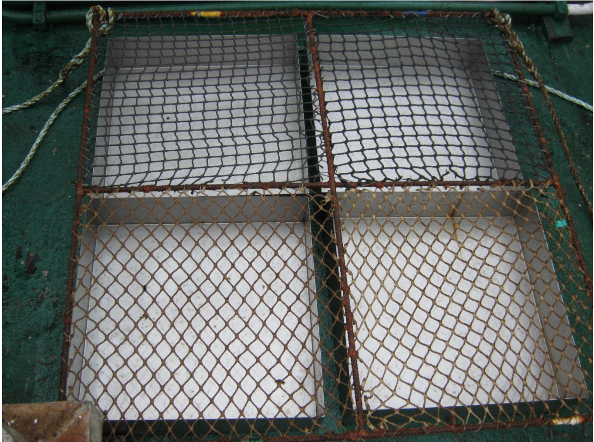
Mynd 2. Fjórir netabútar í einum ramma. Lituð límbönd (tape) sjást á römmunum.
