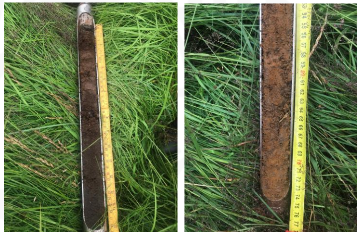
Mynd til vinstri: Mómyndun í kjarna 1004-2. Mynd til hægri: Vatnssorfin mól var áberandi neðst í vestustu kjörnum í mýrinni, sjá bor 1004-5.
