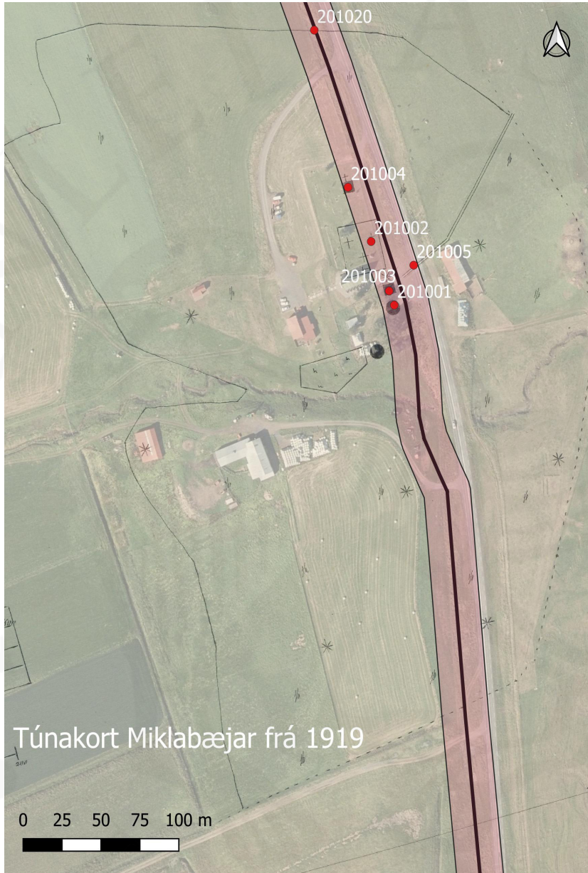
Ábrifasvæði ljósleiðara liggur þvert í gegnum heimatún Miklabæjar SK-201. Fyrirhugað er að plægja í vegöxl þjóðveggar 1 og svæðið er mikið raskað.
