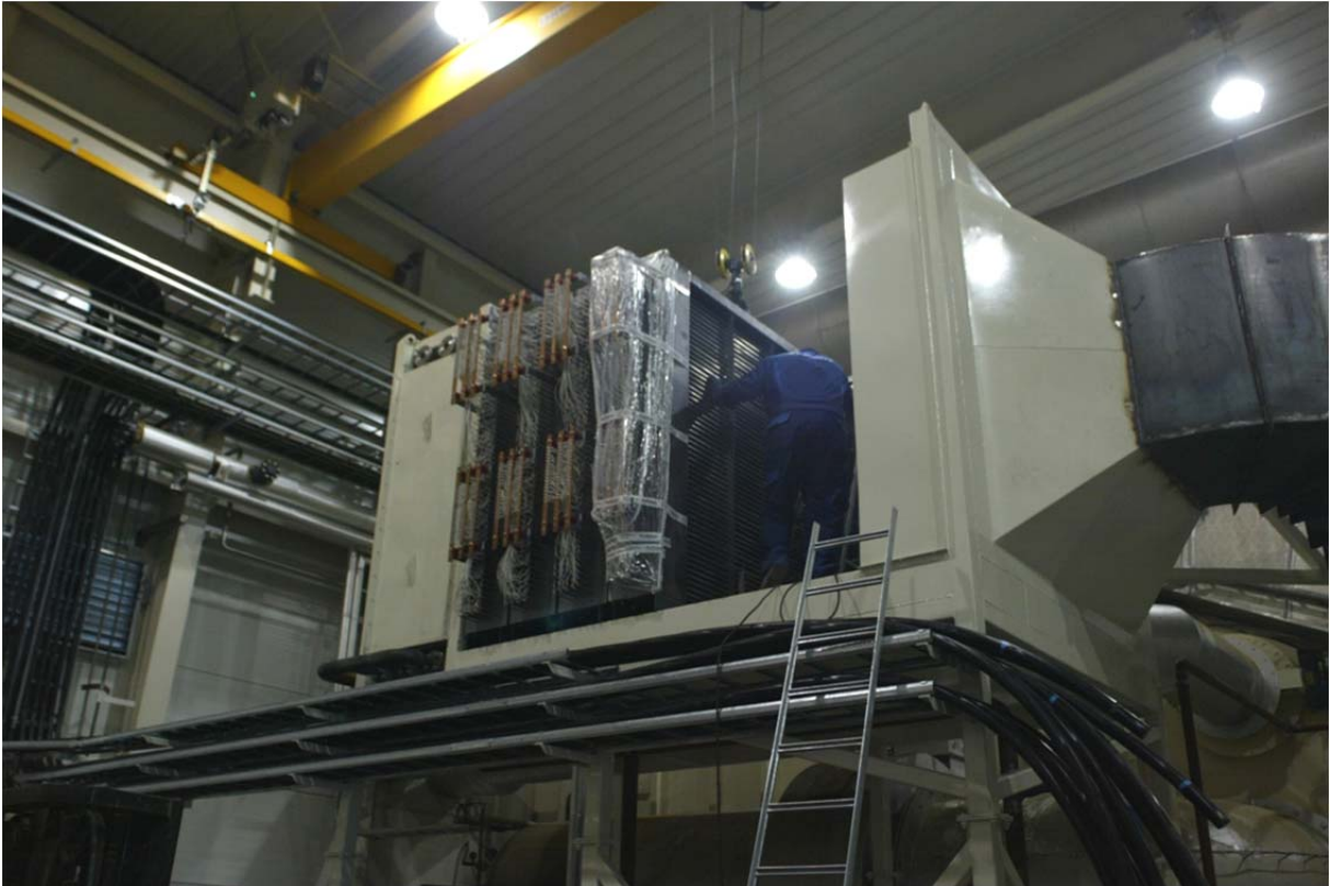
Mynd 14: Hlaupaköttur notaður til að flytja element í og úr hitakassanum.
