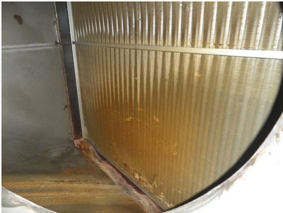
Mynd 23: Sýnir gufuelementið eftir þurrkun á 500 tonnum af hráefni.
