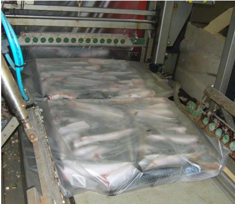
Mynd 21 - Makrílblokk komin í plastumbúðir
