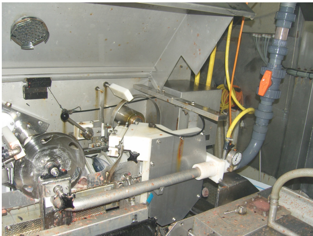
Mynd 18 - Sugan sem sýgur innvflin úr makrílnum, hér hefur hlíf verið lyft svo virkni búnaðarins sé sýnilegri
