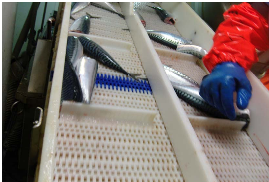
Mynd 12- Hauseður og slægður makrill á leið í frystingu
