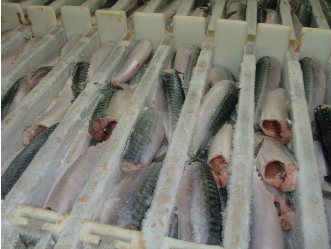
Mynd 20 - Makrill í frystitækjunum eftir að forkældum sjó hefur verið sprautað yfir hann
