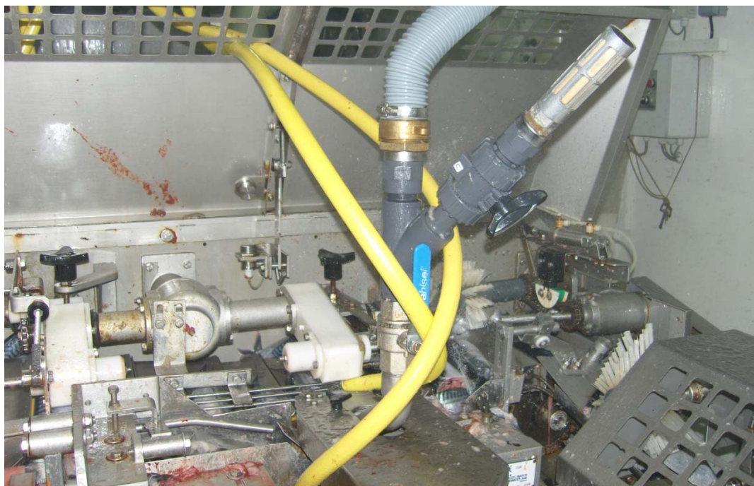
Mynd 8 - Suga sem sýgur innnyflin úr makrílnum
