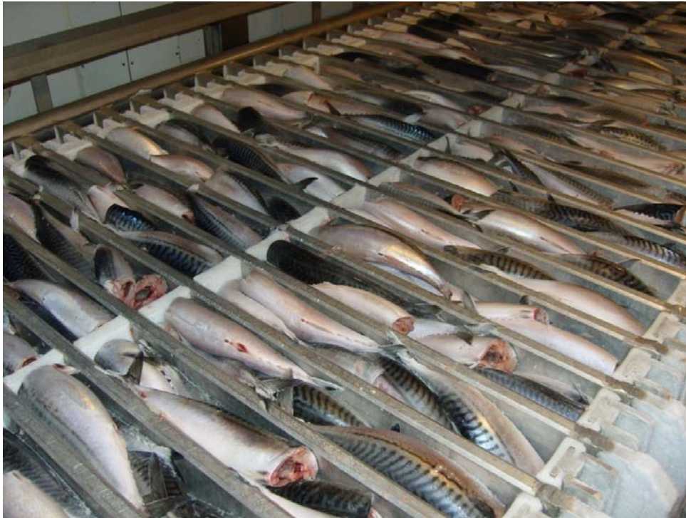
Mynd 9 - MakrÍll í frystitækjum sem frysta hann í blokkir
