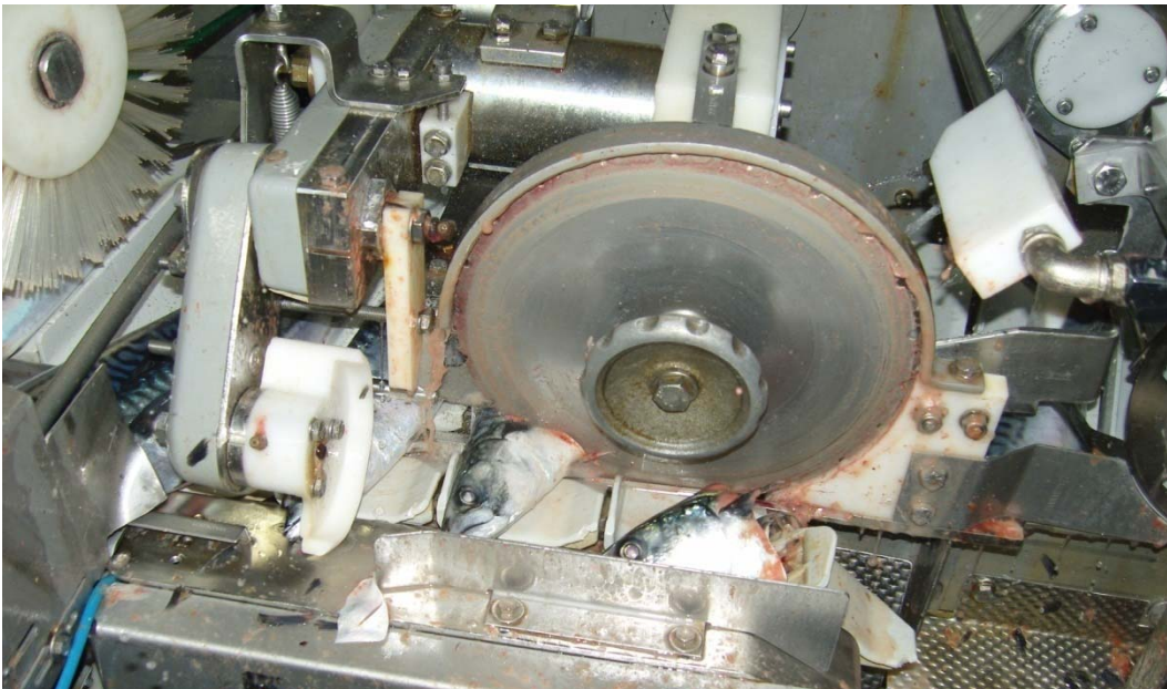
Mynd 17 - Hausari sem sker hausinn af makrilnum
