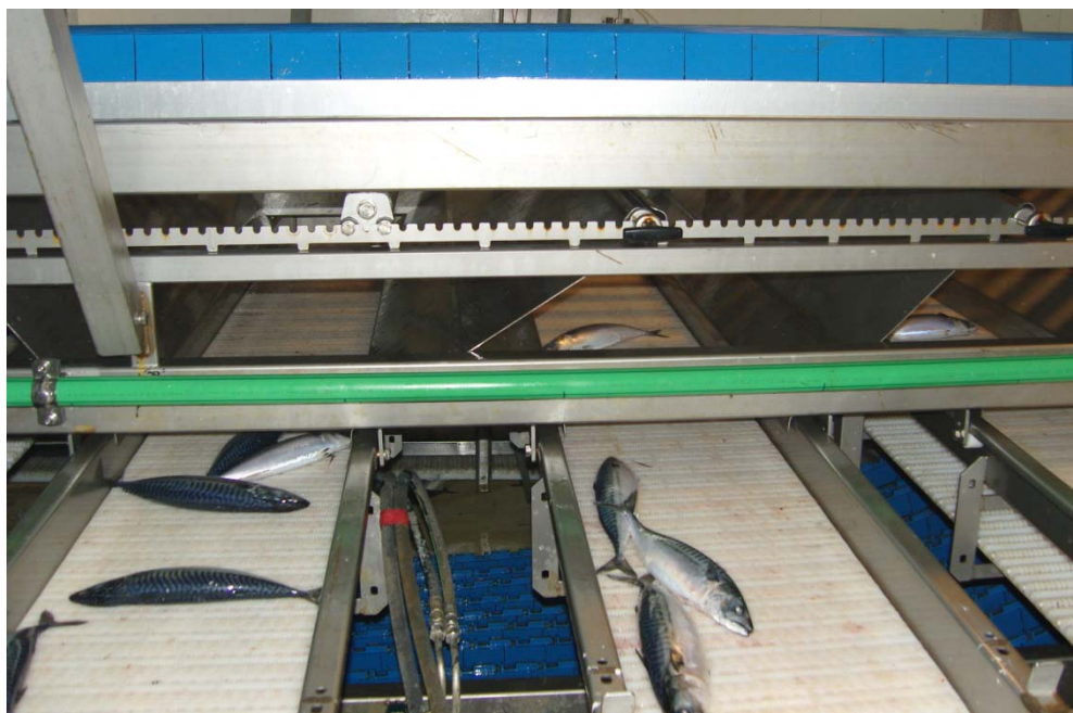
Mynd 5 - Makrill á færriböndum eftir flokkun
