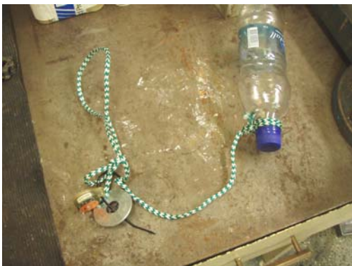
Mynd 40. Onset nemi til að fylgjast með hitastigi í uppþíðingu og lagringu
