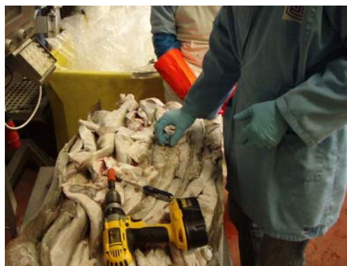
Mynd 18. Ibutton hitanema komið fyrir í kjarna fisks
