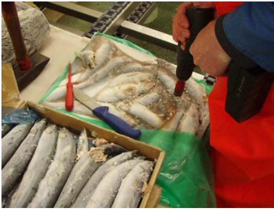
Mynd 11. Borað fyrir ibutton hitanema
