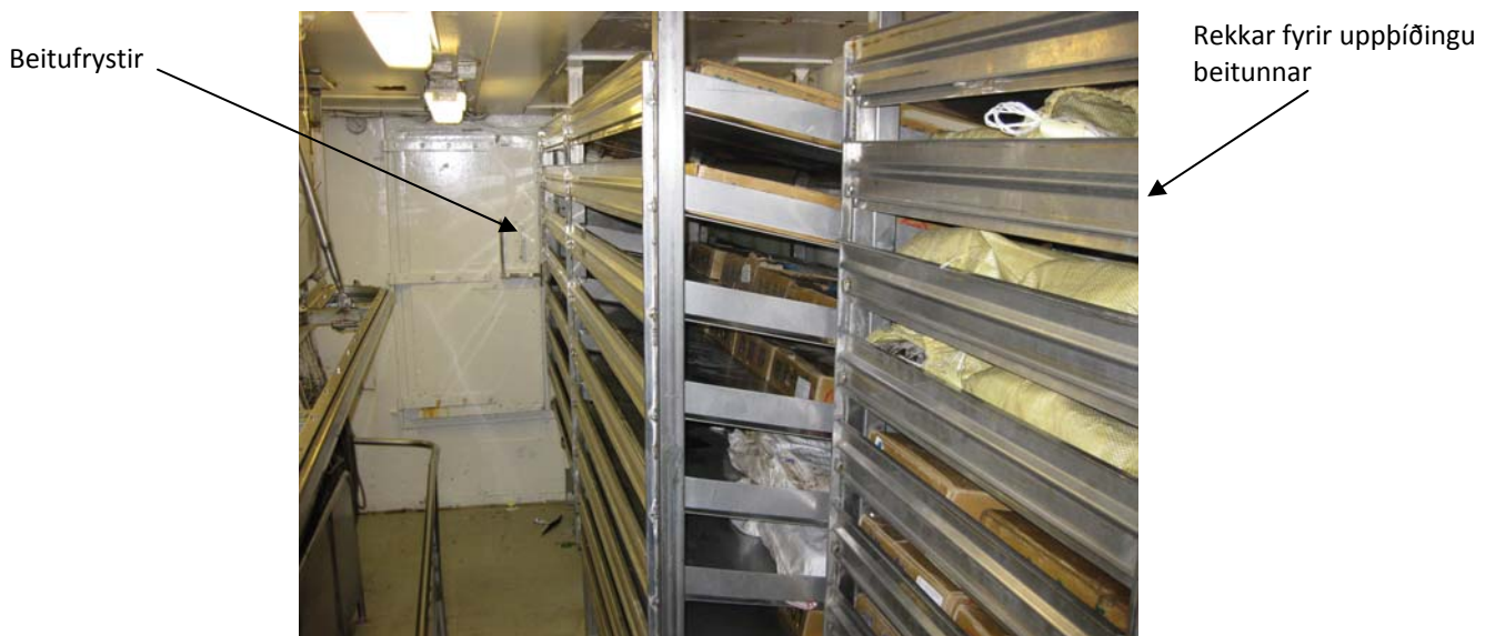
Mynd 4. Aðstaða fyrir uppþíðingu beitunnar eins og hún er í dag, mynd tekin um borð í Sighvati GK
