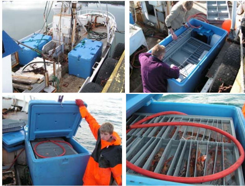
Mynd 13. Uppsetning a geymslukörum með skúffukerfi um borð í Munda Sæm.
