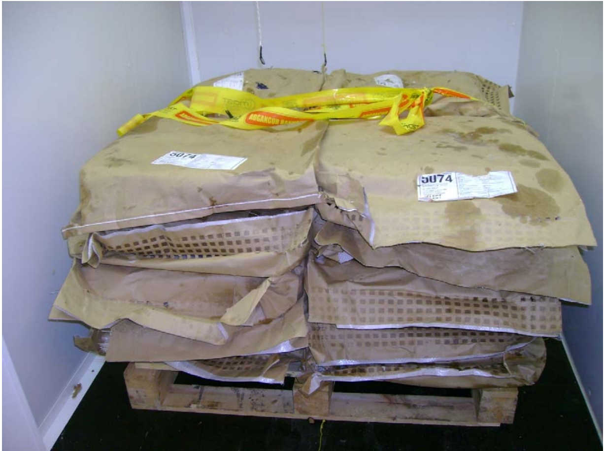
Mynd 6. Tuttugu grálúðupokar í þíðingartilraun inni í hitastýrðum kæliklefa. Fyrir ofan pokana og á gólfi fyrir framan brettið má sjá hitasírta, sem mældu umhverfishitann í tilrauninni.
