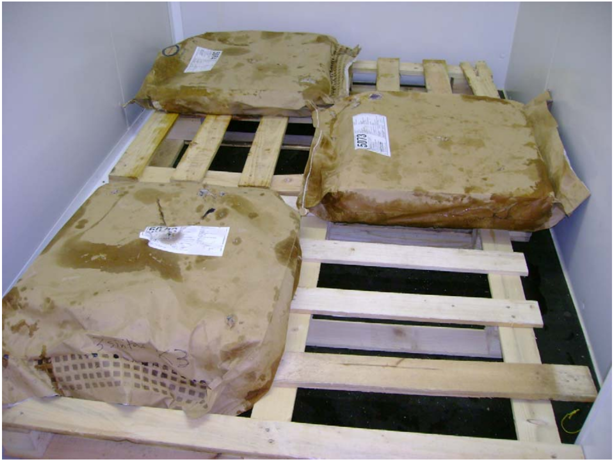
Mynd 8. Uppsetning í lok þíðingartilraunar með þrjá staka poka. Pokinn til hægri (P2) er sýnilega þíðinn. Staðsetningu sírita inni í pokum má sjá á Mynd 4.
