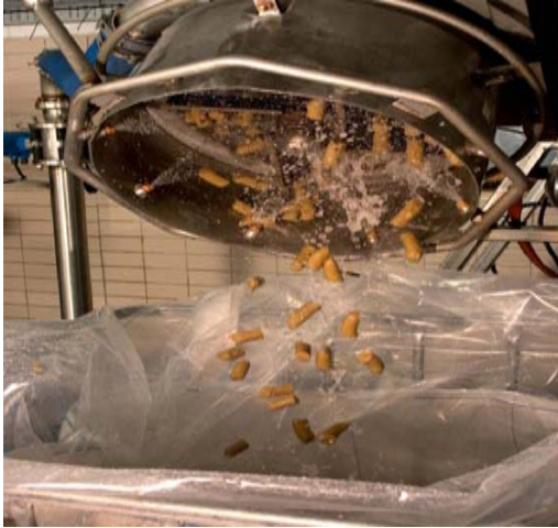
Mynd 2.4 a,b. Pilluskurðarvals þar sem maurasýra ýrist yfir pillur (a) og tilbúnar fóðupillur í stórsekk (b). Fóðupillur eru geymdar í maurasýru í stórsekk.
