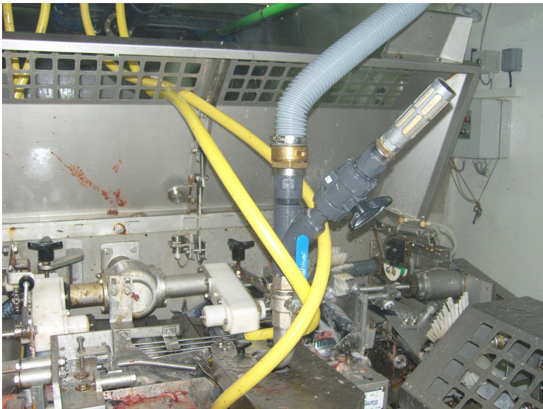
Mynd 4 – Suga sem sýgur innvöðva úr makrílnum
