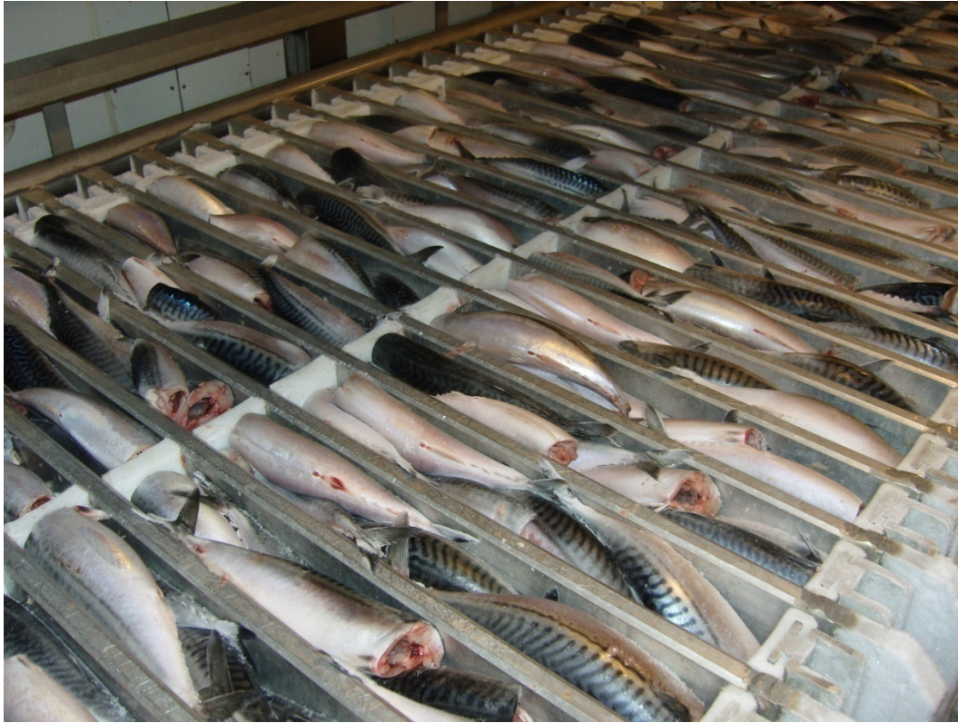
Mynd 6 – Makrill í frystitækjum sem frysta hann í blokkir
