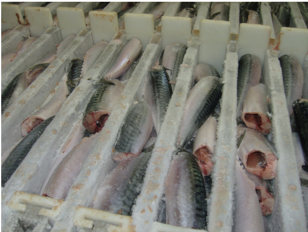
Mynd 15 – Makrill í frystitækjunum eftir að forkældum sjó hefur verið sprautað yfir hann
