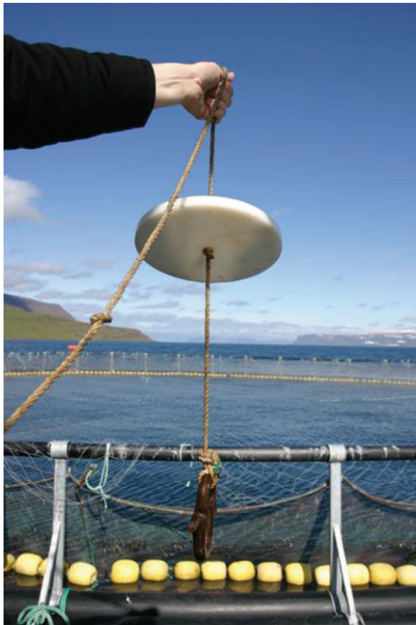
Mynd 2.13. Sjónkýpi mælt með skífu (Ljósmynd: Valdimar Ingi Gunnarsson).
