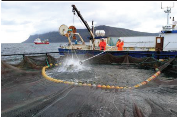
Mynd 4.28. Perlufesti notuð til að þrengja að fiski í söfnunarkví (Ljósmynd: Valdimar Ingi Gunnarsson).
