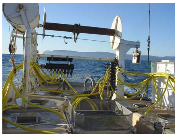
Mynd 6.22. Sjódælukerfi og kör sem notuð voru undir flutning á lifandi þorski um borð í Vali ÍS-20 (Ljósmynd: Þórarinn Ólafsson).
