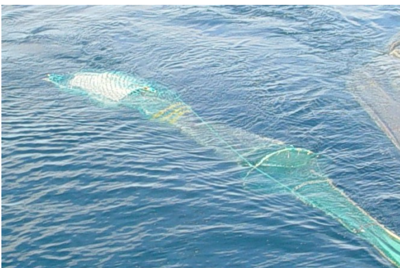
Mynd 4.42. Á myndinni má sjá tvær stálgjardir sem notaðar eru til að halda neðri hluta hólksins og pokanum betur opnum. Myndin er tekin um borð í Val ÍS 20 (Ljósmynd: Þórarinn Ólafsson).
