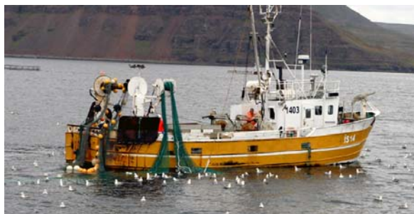
Mynd 4.51. Lyftipoki tilbúinn til hífingar um borð í Halldór Sigurðsson ÍS 14 (Ljósmynd: Valdimar Ingi Gunnarsson).
