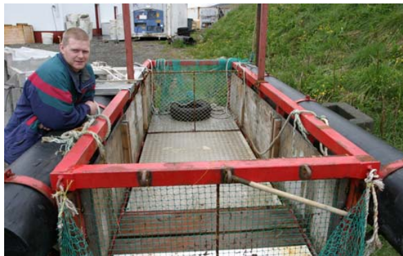
Mynd 7.20. Flotprammi hjá Þorskeldi ehf. sem notaður er til að flytja fisk úr söfnunarkví yfir í eldiskví (Ljósmynd: Valdimar Ingi Gunnarsson).
