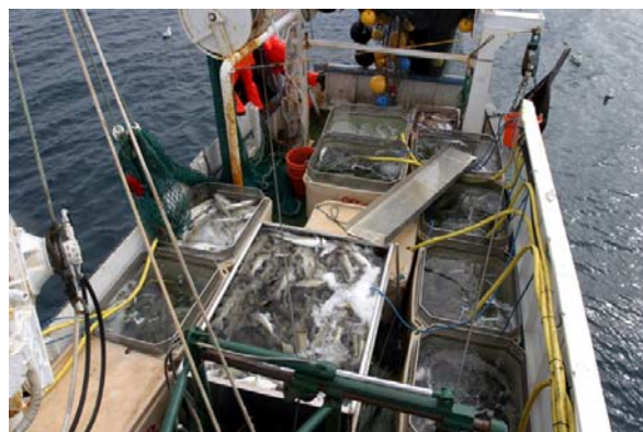
Mynd 5.2. Á miðju dekki er móttökukar fullt af sjó um borð í Vali ÍS 20 (Ljósmynd: Valdimar Ingi Gunnarsson).
