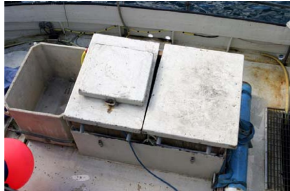
Mynd 6.6. Lok ofan á tanki takmarkar birtu (Ljósmynd: Valdimar Ingi Gunnarsson).
