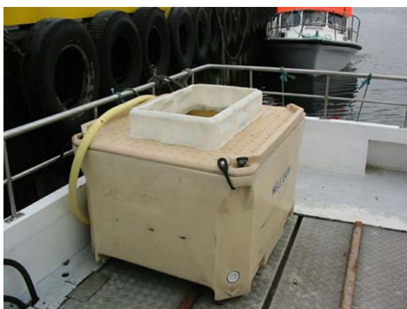
Mynd 6.15. Fiskikar með lúgu til að auðvelda losun í kar og til að varna því að fiskur fari úr kari í veltingi (Ljósmynd: Óttar Már Ingvason).
