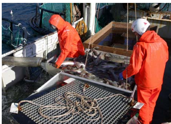
Mynd 6.17. Tvöfaldur tankur um borð í Halldóri Sigurðssyni ÍS 14. Fremst sést hillan sem tekin hefur verið upp og fjær er verið að lyfta falska botninum til að losa fisk úr tankinum (Ljósmynd: Valdimar Ingi Gunnarsson).
