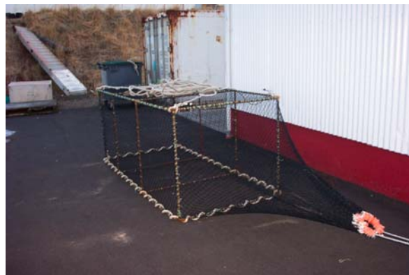
Mynd 5.18. Búr sem notað var hjá Þorskeldi ehf. til að ná lofti úr flotþorskum með því að sökkva því vel undir yfirboð sjávar (Ljósmynd: Elís Hlynur Grétarsson).
