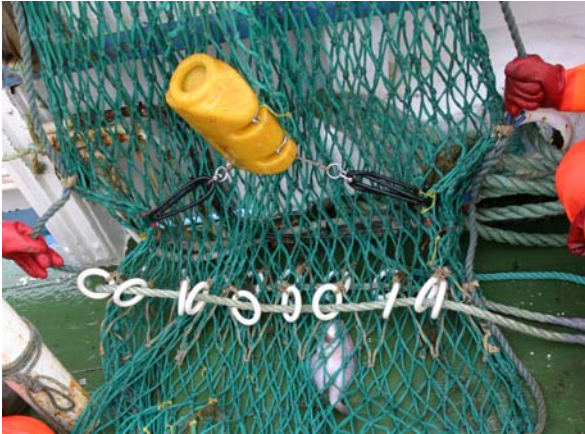
Mynd 4.48. Aflnemi sem gefur upplýsingar um afla er hafður framan við gjörð og strekkt er á teygjuni til að auka næmni hans.
