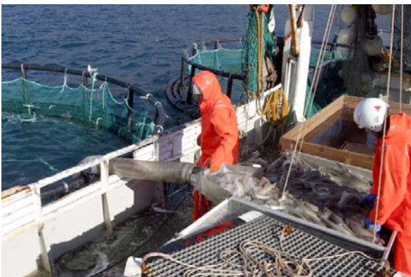
Mynd 7.10. Þorskur losaður úr flutningstanki um borð í Halldóri Sigurðssyni ÍS 14. Fölskum botni lyft upp í flutningstanki og þorskur látinn renna út um barka yfir í söfnunarkví (Ljósmynd: Valdimar Ingi Gunnarsson).
