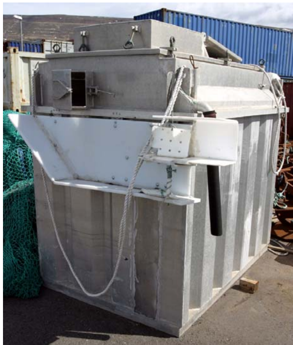
Mynd 6.16. Flutningstankur sem notaður hefur verið um borð í bátum hjá Brim-fiskeldi ehf. (Ljósmynd: Valdimar Ingi Gunnarsson).
