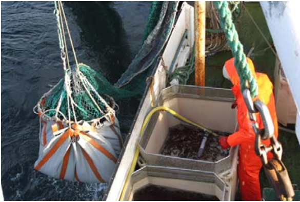
Mynd 4.35. Þorskseiði hífið um borð í segklæddum poka um borð í Val ÍS 20. Hafður er hringur í staðinn fyrir gjörð til að koma í veg fyrir að þrengt sé að fiskinum (Ljósmynd: Valdimar Ingi Gunnarsson).
