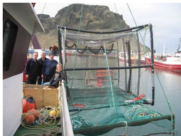
Mynd 4.22. Stóra kassagildran utan á Bylgju VE 75. Gildran sem hönnuð var og smíðuð af starfsmönnum Kvíar ehf. er 4 m löng, 3 m breið og 3 m á hæð (Mynd: Kristján Óskarsson).
