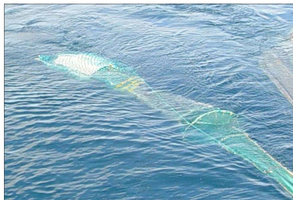
Mynd 3.6. Á myndinni má sjá tvær stálgjarðir í rækjuvörpu sem notuð er til að halda neðri hluta belgsins og pokanum betur opnum (Ljós.: Þórarinn Ólafsson).
