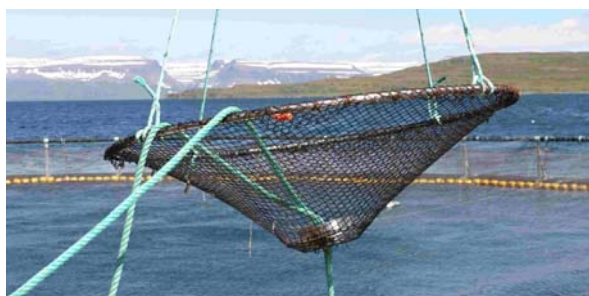
31. mynd. Dauðfiskaháfur hjá Hraðfrystihúsinu-Gunnvöru hf. til að fjarlægja dauðan fisk úr sjókví (Mynd: Valdimar Ingi Gunnarsson).
