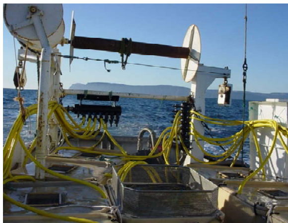
17. mynd. Sjóðælukerfi og kör sem notuð eru undir flutning á lifandi þorski fyrir Hraðfrystihúsið Gunnvöru um borð í Vali ÍS-20 (Mynd: Þórarinn Ólafsson).
