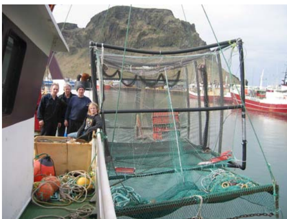
13. mynd. Stóra kassagildran utan á Bylgju VE 75. Gildran var hönnuð og smíðuð af starfsmönnum Kvíar ehf. og er hún þrjú m á hæð, fjögurra m löng og þriggja m breið (Mynd: Kristján Óskarsson).
