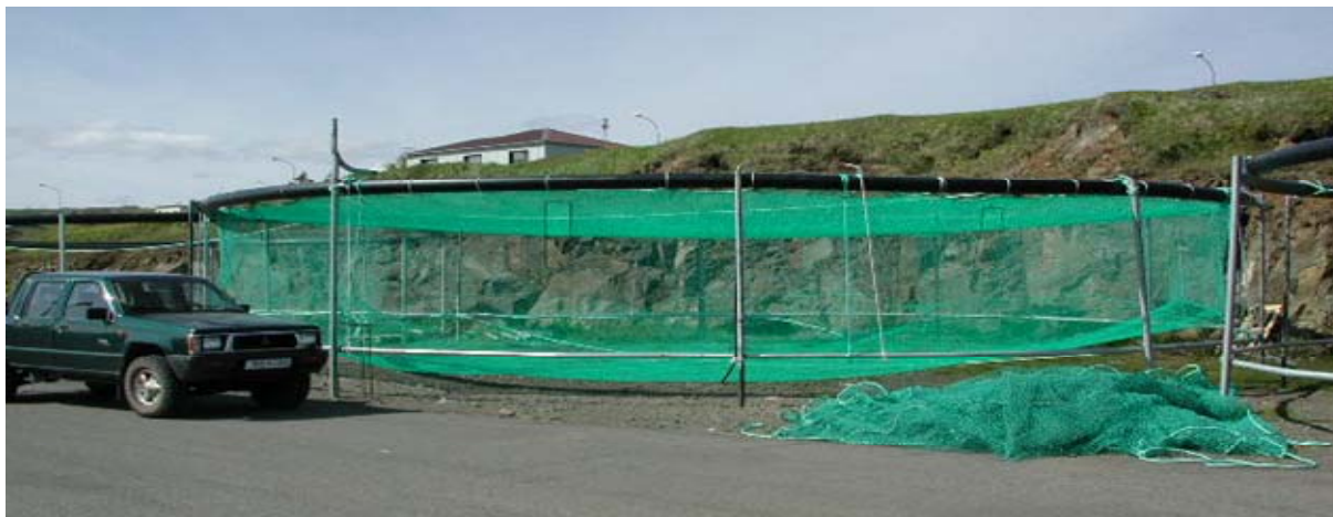
14. mynd. Eldisgildra hönnuð og smíðuð á vegum Vopn-fisks ehf. á Vopnafirði (Mynd: Guðmundur W. Guðmundsson).
