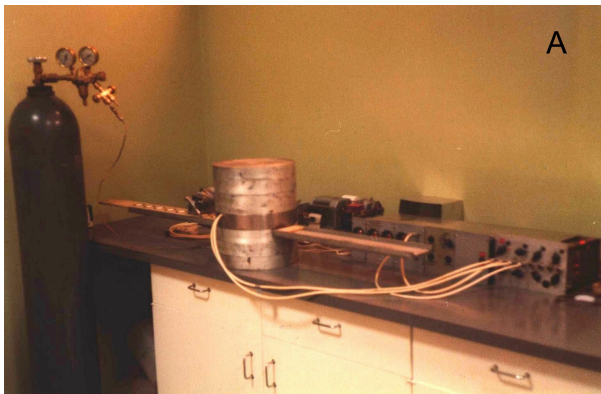
3. mynd. Geigerteljarar, (A) PS-II með glóðarlömpum, notaður frá 1965 til 1983 og (B) PPC-1, sem var með fjórum nemum og rökrásum, kom til sögunnar árið 1985.
