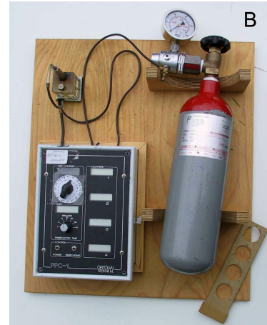
3. mynd. Geigerteljarar, (A) PS-II með glóðarlömpum, notaður frá 1965 til 1983 og (B) PPC-1, sem var með fjórum nemum og rökrásum, kom til sögunnar árið 1985.
