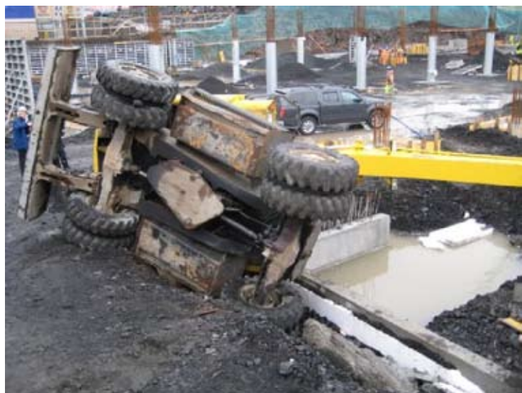
Þessi hjólagrafa valt á hliðina vegna þess að grafan var of nálægt kanti sem gaf sig.
