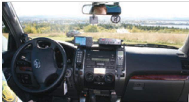
Radar, upptökuþæki, talstöð, sími, GPS og fleira.
