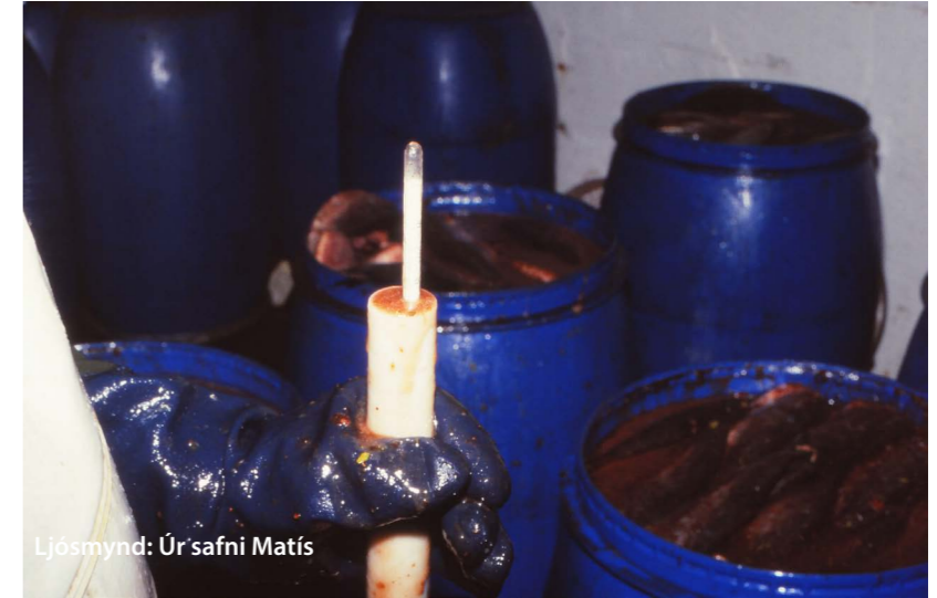
Styrkur pækils mældur með flotmæli
