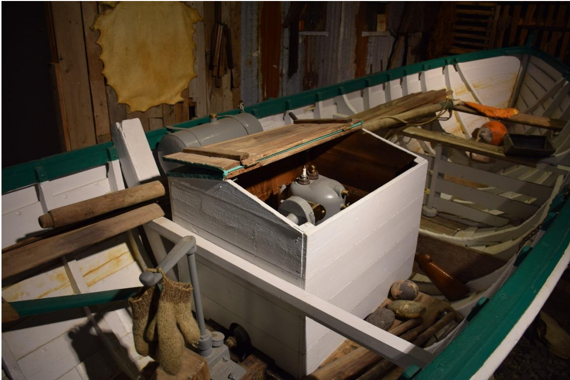
4,5 hestafla Sleipner vél hefur verið í Brönu síðan 1950. Ljós. Ágúst Ólafur Georgsson.
