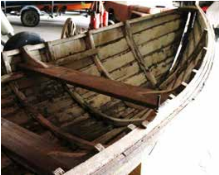
Svalvogabáturinn. Byrðingurinn er að losna frá stefninu vegna áhrifa frá frosti og sól. Ljósmynd. HMS 2018
