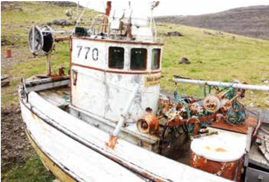
Stýrishús og dekk Skúla Hjartarsonar BA 250, 2018. Á dekkinu er búnaður til snurvoðaveiða, smíðaður á Þingeyri. 48 Ljós. HMS 2018
