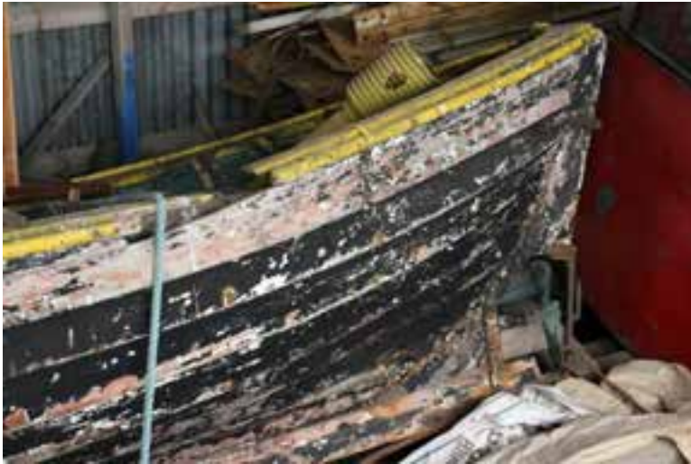
Skjögtarinn Fluga í skemmu á Hnjóti, afturhluti. Skrófan er á sínum stað. Borðstokkurinn hefur orðið fyrir hnjaski. Ljós. HMS 2018
