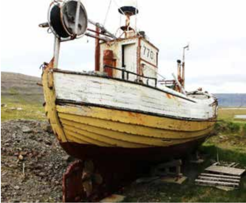
Skutur Skúla Hjartarsonar BA 250, 2018. Búnaðurinn á afturdekkinu er sennilega fyrir snurvoð. Ljós. HMS
