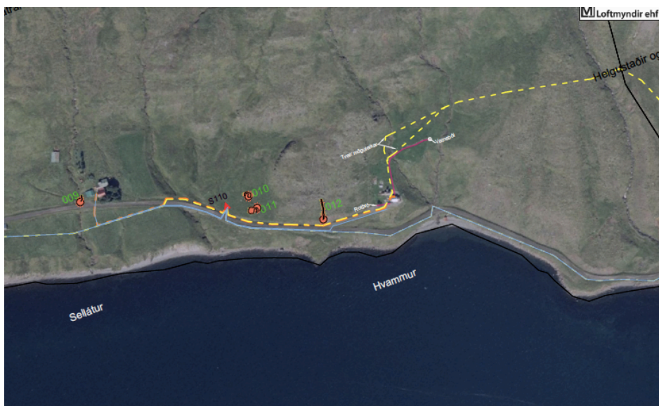
Mynd 4. Breytt lagnaleið að Hvammi sýnd með gulri strikalinu, þegar skráð lagnaleið sýnd með gulri og blárra strikalinu. Sýndir eru tveir möguleikar fyrir lagnaleiðir. Rarik.
