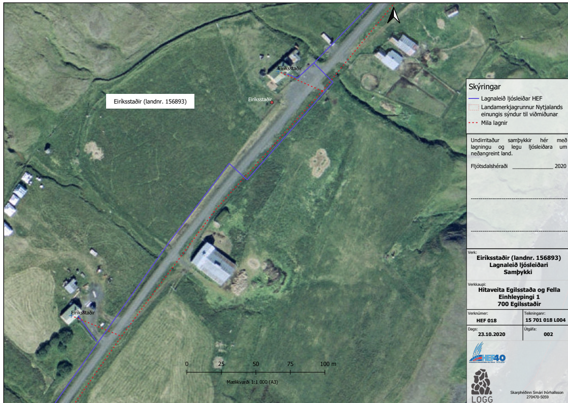
Mynd 1. Loftmynd af áætluðum breytingum á línulögn ljósleiðara hjá Eiríksstöðum. Breytt leið færð inn með blárrí línu. Ljósleiðari Milu færður inn með rauðri stríkalínu.
