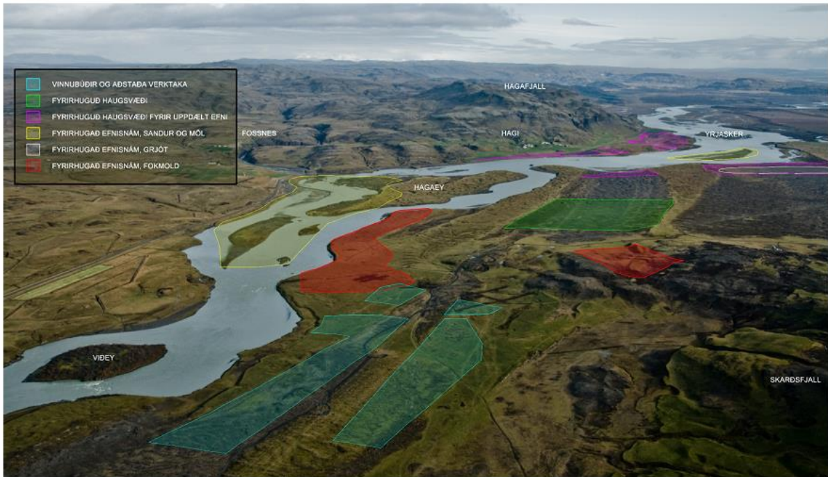
Mynd 4 Horft í norður yfir framkvæmdasvæðið. Myndin sýnir efnistökusvæði, haugsetningu, vinnubúðir og aðstöðu verktaka. Mynd tekin úr skýrslu Mannvits og Verkís [7] og er að finna í stærri upplausn í Viðauka 1.
