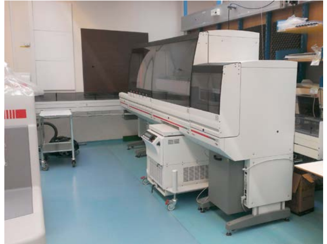
Flæðilínan kemur sýnunum á Vitros 5.1 tækin, bún inniheldur skilvindu og tappatogara.
