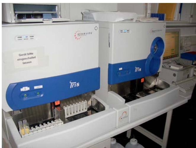
Hér er tæki sem mælir þvagsýni kemískt og „smásjárskoðar“. Myndir af „elementum“ í sýninu birtast á skjá sem er til blíðar við tækið.
