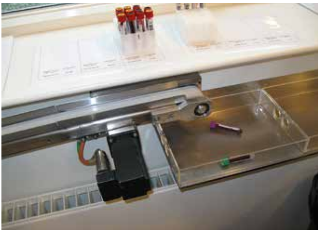
Mynd 3. Hér má sjá færibaldið og bakkann sem sýnaglösin detta ofan í.
