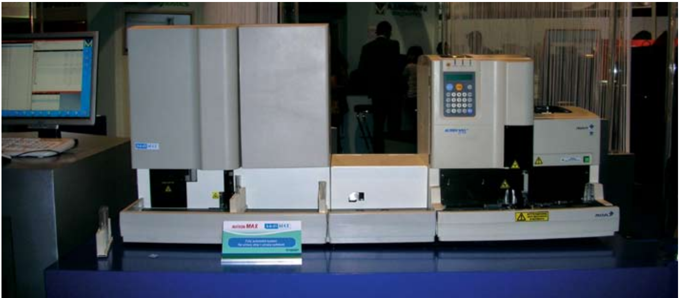
Aution MAX / sediMAX tækið, sem auk þess að gera strimilsefnarannsóknir á þvagi, tekur myndir af elementum í þvagbotnsfalli til vinnslu í tölvu.
