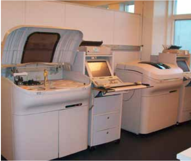
Mynd 6. Hitachi 912 tækin fyrir allar lífefnafræðilegar mælingar, einnig lyf og HbA1c. Tækin tvö eru nákvæmlega eins og eru bæði notuð á virkum dögum.
