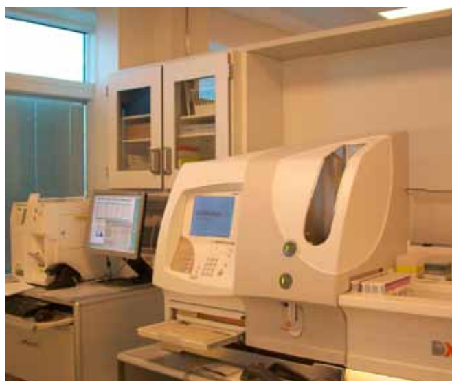
Mynd 5. Pentra DX 120 blóðhagstækið er notað fyrir flest sýnin en litla tækið nær glugganum er fyrir microsýni og mælir bæði blóðhag og CRP.
