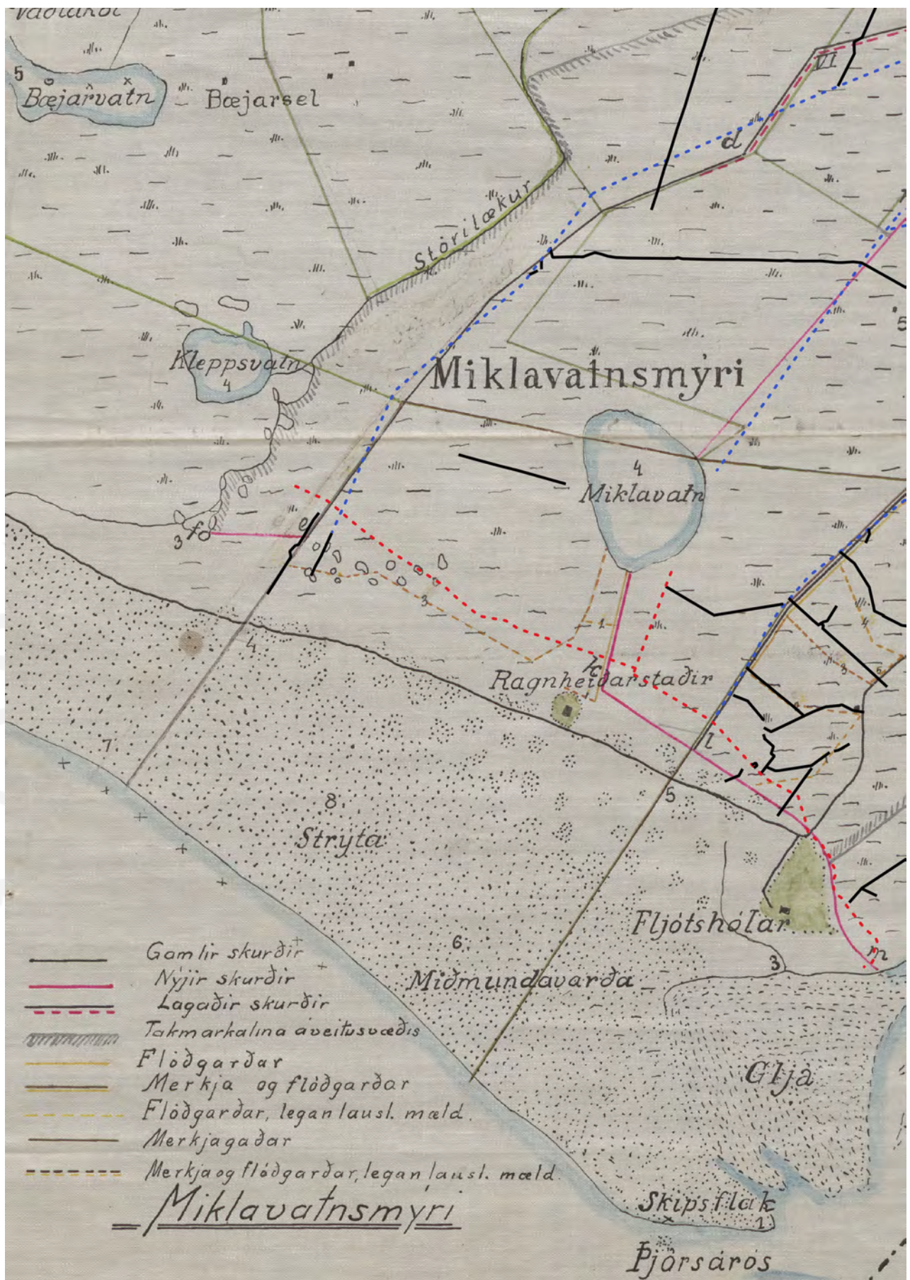
Á myndinni er hluti af áveitukorti Miklavatnsmýraráveitu sem voru gerð ofan á herforingjaráðskort árið 1919, eftir að áveitan var tekin í notkun. Hér sést vel hvernig hönnun og raunveruleika ber ekki saman, svartar línur eru flóðgarðar, rauðar punktalínur eru þurrkskurðir og bláar punktalínur aðfærsluskurðir. ©Þjóðskjalasafn Íslands og Fornleifastofnun Íslands.
