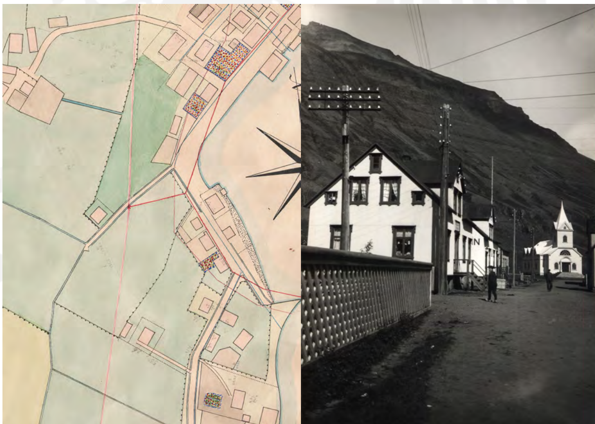
Rafveitan á Seyðisfirði er teiknuð inn á Kaupstaðarkort frá 1915-1920 (rauðar línur). Sverari línur eru fyrir háspennu og finni línur fyrir lágspennu. Á þessum hluta kortins má sjá Norðurgötu og hluta af Vesturvegi.
