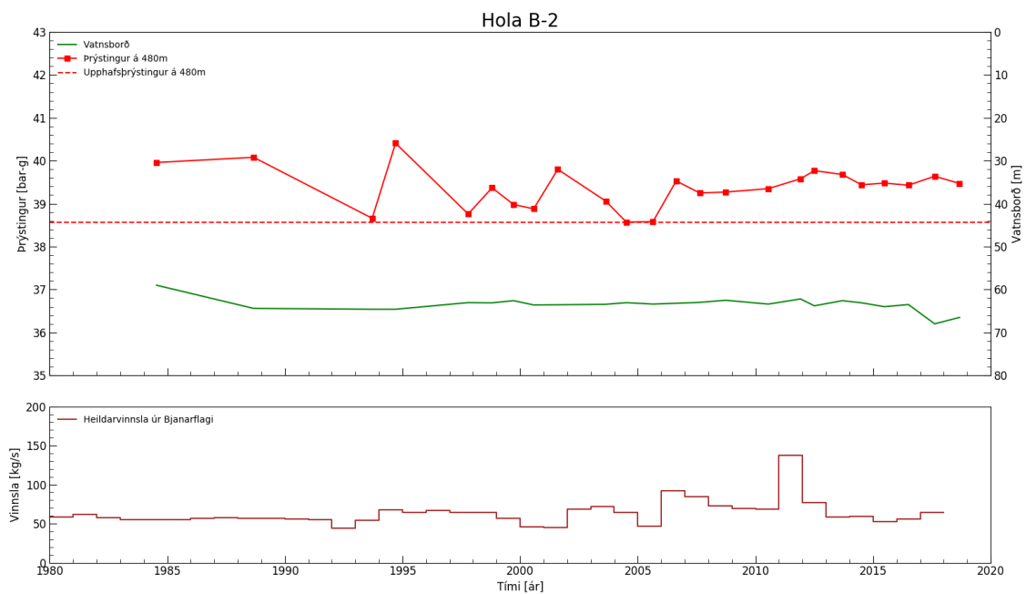
Mynd 21. Mældur þrýstingur á 480 m dýpi í holu B-2 ásamt metnum upphafsprýstingi og mældu vatnsborði. Þá sýnir myndin einnig vinnslusöguna í Bjarnarflagi fram til ársins 2018.
