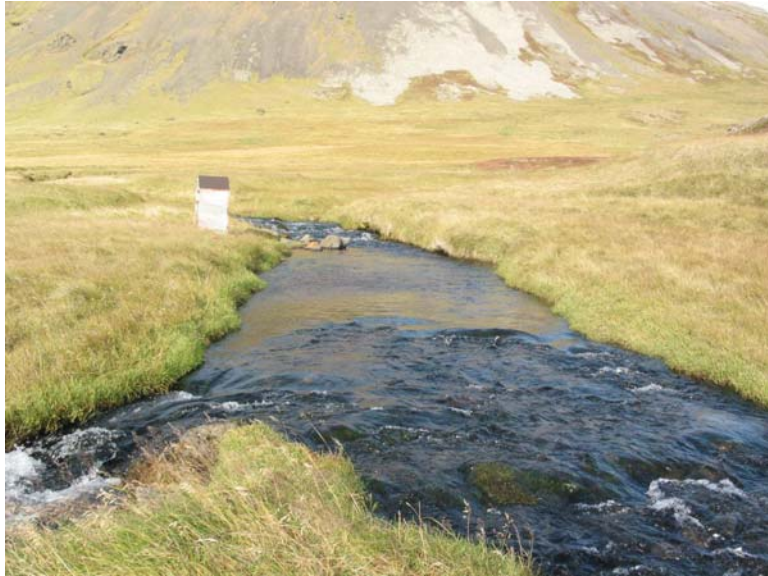
Mynd 2: Mælistaðurinn V2359. Mynd frá 28. september 2006. Síritahúsið á hægri bakka og ráðandi þversniði fremst. Grímsá kemur niður úr skarðinu til hægri.
