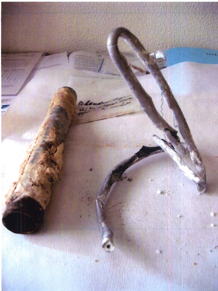
Mynd 4. Element og rörbútur sem útfellingasýni voru tekin af. Utan á rörinu eru leifar af einangrun. Útfellingasýni var tekið innan úr röri.
