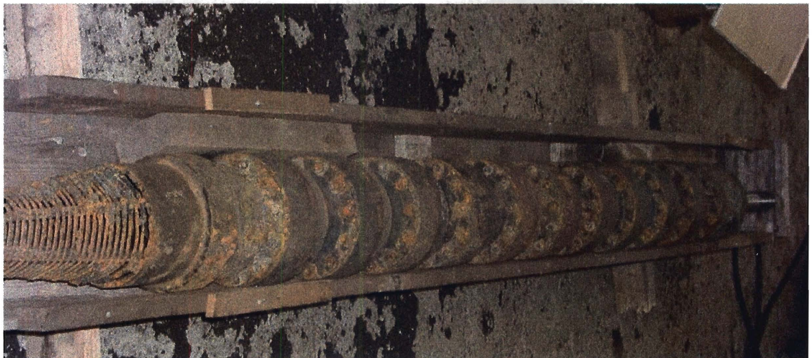
Mynd 1. Djúpdælan úr holu GN-1 við mótöku á Vélaverkstæði Sigurðar. Dælan er af tegundinni Floway 8 JKH, 10 þrepa.
