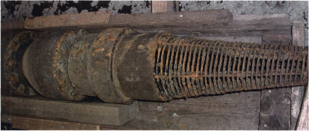
Mynd 2. Botnsigti dællunnar. Teinarnir eru ryðgaðir og á þeim frauðkenndar ryðbólur. Sama er að segja um stálbolta sem halda þrepunum saman. Stálsteypa í dæluhúsum er ótærð. Engin merki útfellinga.
