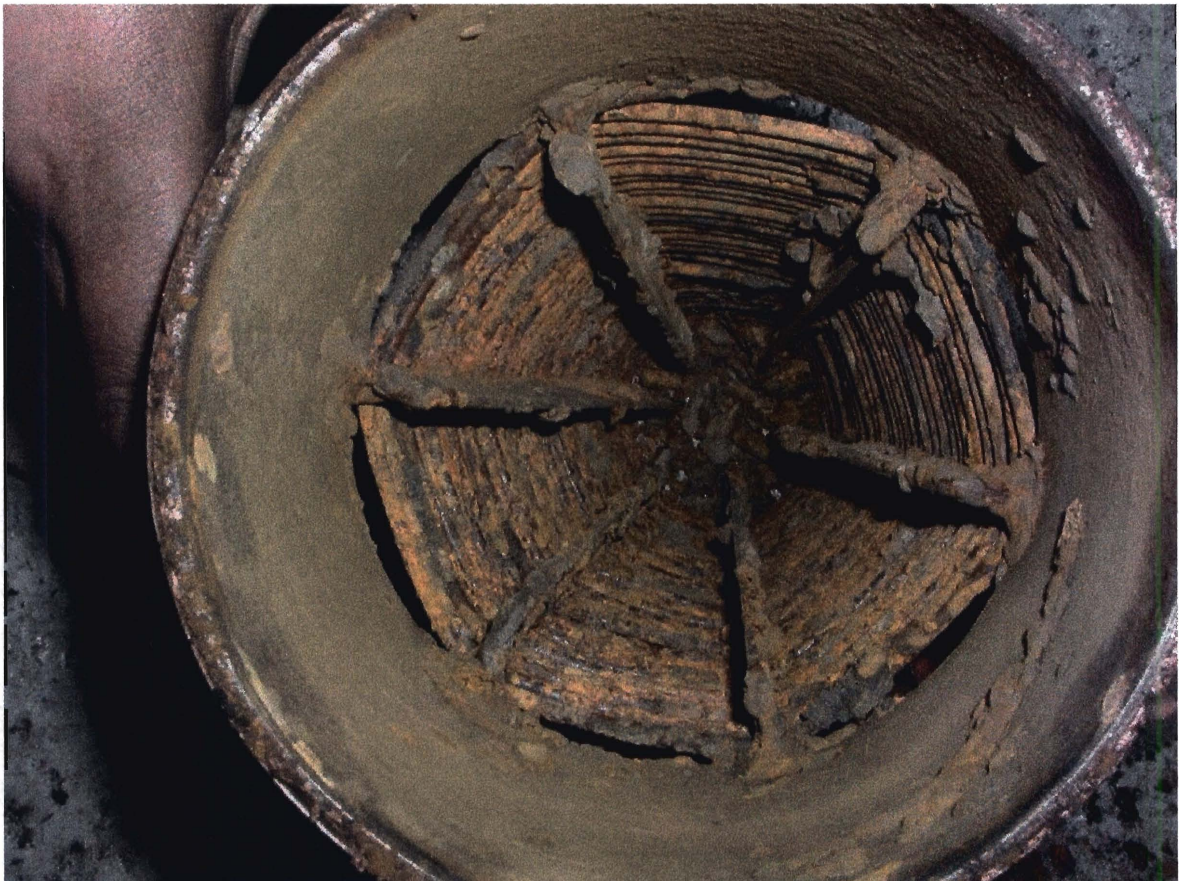
Mynd 3. Botnsigti séð innan frá. Ryðhrúður á teinum í sigti. Engin útfelling.
