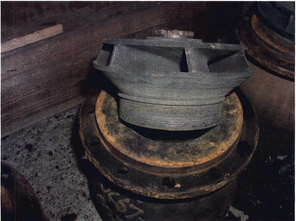
Mynd 12. Dælujól séð frá hlið. Háls (þétting) á soghlið hjóls er eilítið slitinn.
