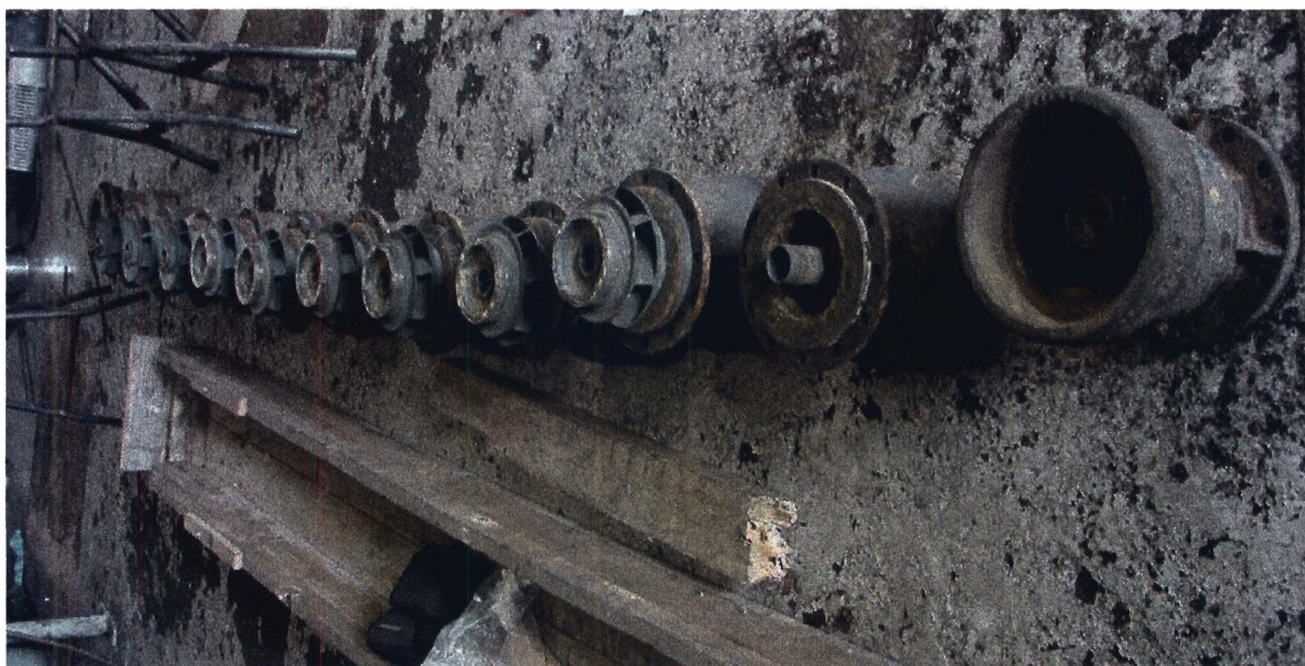
Mynd 8. Dæluprepin tíu í pörtum. Sex efstu þrepin eru “þrýstiballanseruð” þ.e. með þéttingu einnig á bakhlíð til að minnka tog á dæluöxul.
