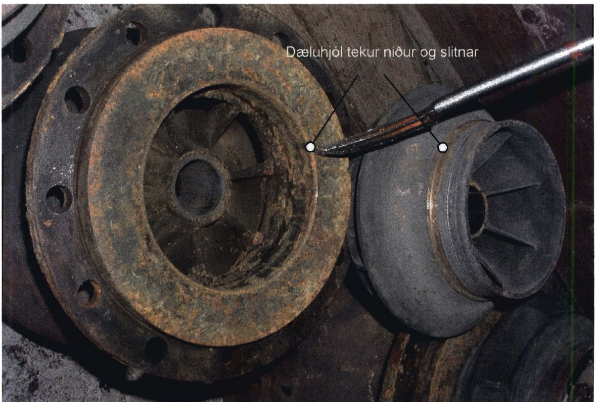
Mynd 15. Dæluhjól sem hefur tekið niður í hús næsta þreps. Þetta bendir til að endaslag dæluhunnar hafi verið á mörkum þess sem leyfilegt er og ástæða til að huga að því við næstu niðursetningu. Þetta nudd hefur þó ekki valdið tjóni á dæluinni því dæluhjólið hefur slitnað og dælan ekki festst.
