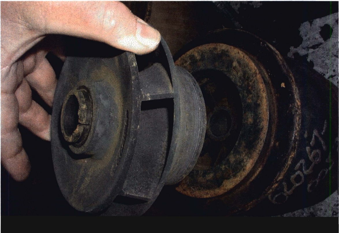
Mynd 11. Dæluhjól (ekki “þrýstiballanserað”) og næsta dæluhús þar fyrir neðan. Hvorki tæring né útfelling á dæluhjóli.
