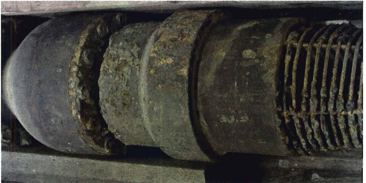
Mynd 4. Nærmynd af neðsta þrepi. Tæringahrúður á boltum og sigti á inntaki dælnnar
