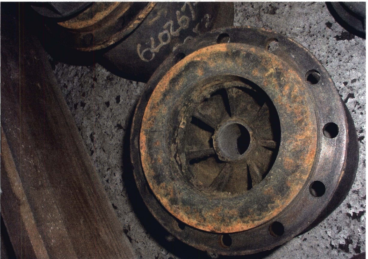
Mynd 13. Dæluhús að ofan. Engin útfelling eða óhreinindi og óveruleg tæring.
