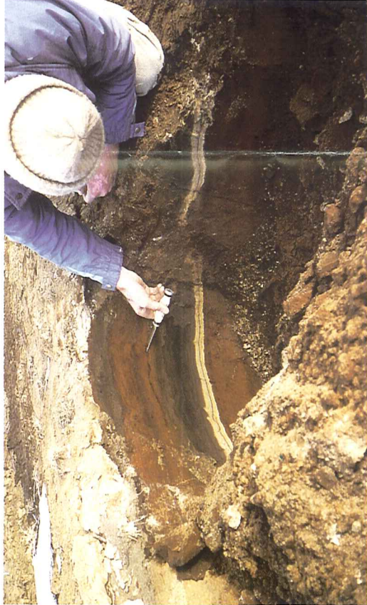
Könnun öskulaga við jarðfræðikortlagningu á Mývatnssvæðinu. Ljósá og dökka öskulagið (ljóst efst og dökkt neðst) í þversniðinu er 4500 ára gamalt Hekluag. Annað Hekluag um 3000 ára gamalt er á gryfjubruninni. Takið eftir svörtu rákinni í miðju ljósa laginu. Ljósni. Ólafur G. Flóvenz.
