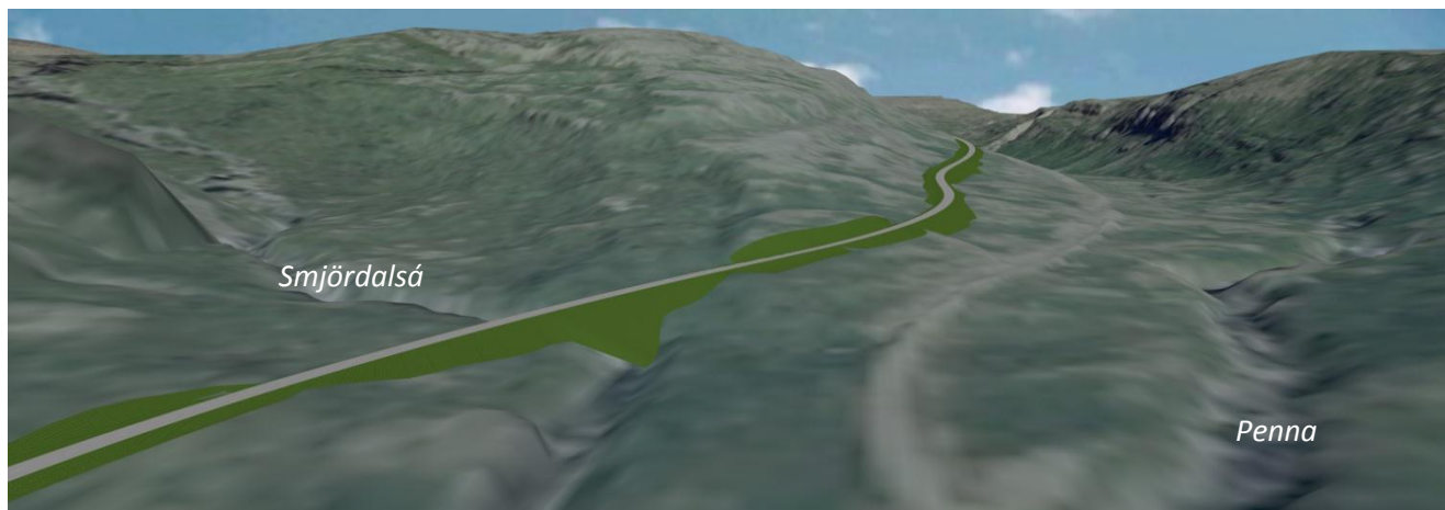
Þrívíddamynd 1. Skeringar og fyllingar frá ca stöð 3100-3900 á veglínunum A2, A3, F og F3. Mynd: Loftmyndir ehf/Karl Arnar Arnarsson.
