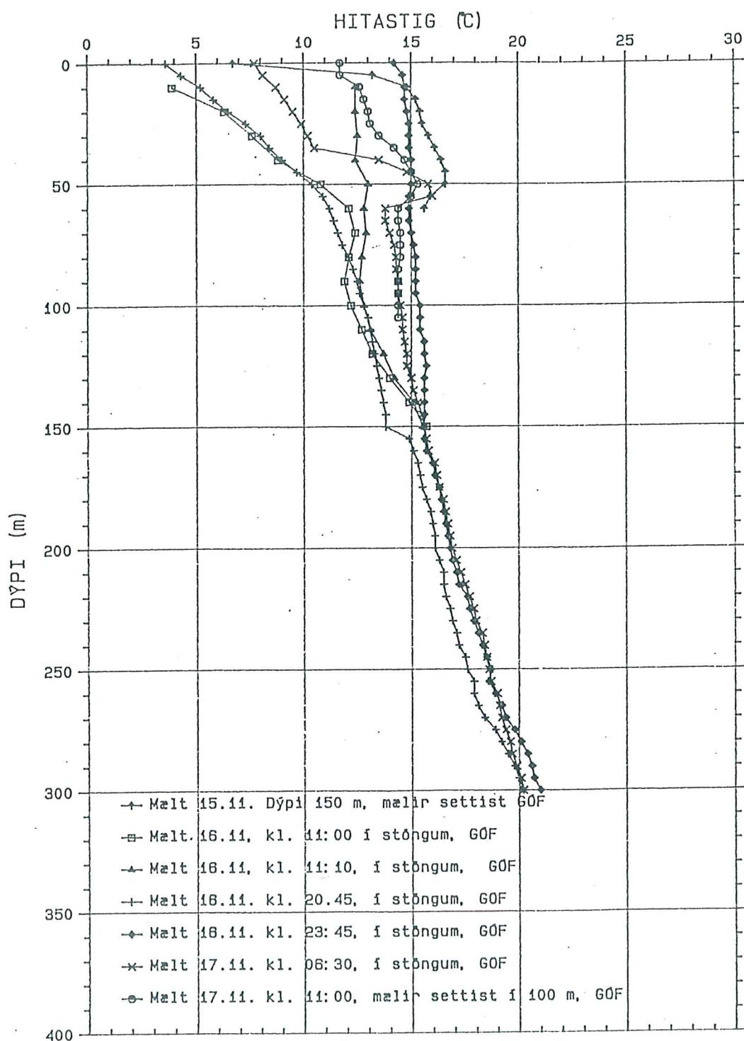
til að mest af vatninu sé ættað ofan 150 m dýpis. Á hitamælingum eftir borun (mynd 2) virðist þó mega greina vatnsæðar nærri 150 m dýpi, 220 m dýpi og á 255 m dýpi. Holan var loftdæld í 1/2 klst eftir borun til hreinsunar, afkastamælingar og sýnatöku (sýni 2), og lauk loftdælingu kl 19:00, 16. nóvember.
