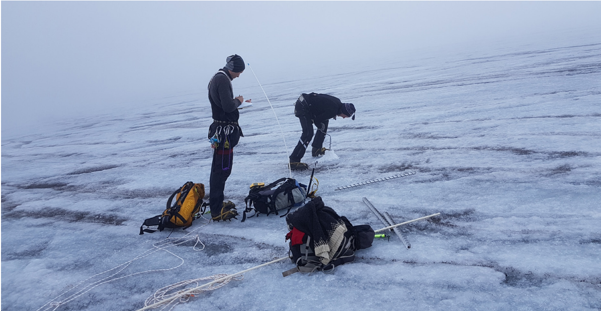
4. mynd. Mælingamenn á Deildardalsjökli. Lesið af leysingastiku annarsvegar og boruð 4 m hola með snigilbor fyrir nýja leysingastiku hinsvegar. Sú nýja tekur við þegar sú eldri fellur vegna bráðnunar á leysingasvæði jökulsins. Ljósmynd. Sveinn Brynjólfsson, 10. september 2019.
