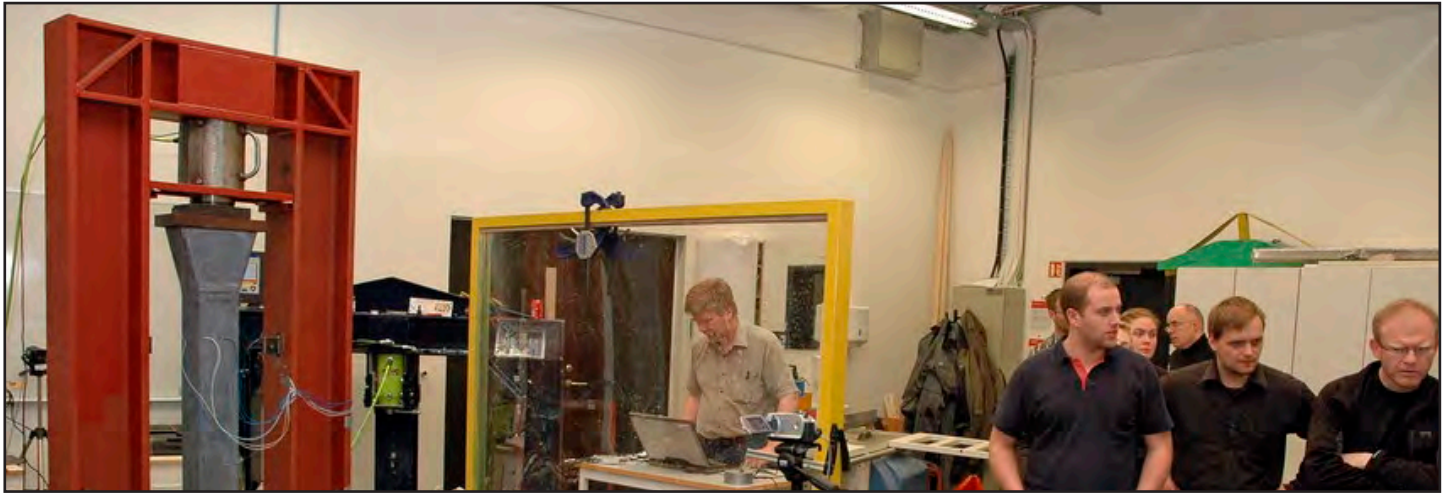
Eiríkur rauði (brotpressa) tekur á steyptri súlu umvafinni basaltrefjamottum - nemendur og kennarar fylgjast með rannsókn meistaranema í byggingarverkfræði.
