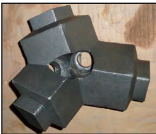
Mynd 7. Tilbúið horn með boltagötum sýnir greinilega veikingu hornanna sem boltaaðferðin skapar og auðvelt er að ímynda sér spennutoppa við götin. Hornin eru steipt úr stálsteypu
