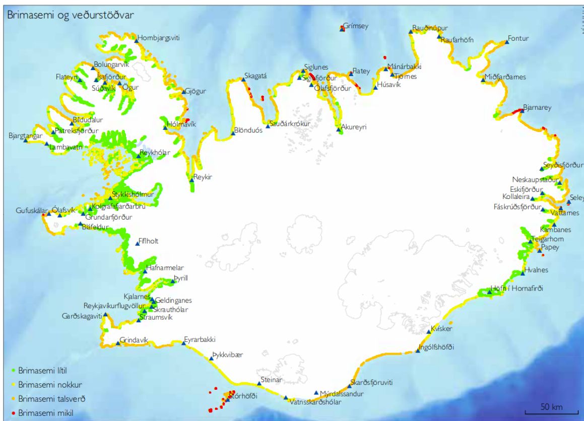
Reiknuð gjöld, alls 246,623, á dlagsstuðli brims (REI-index) flokkuð í fjögur veldishækkandi stærðarbil: lítil brimasemi (0–8000); nokkur (8001–32.000); talsverð (32.001–128.000); og mikil ( >128.000 ).
