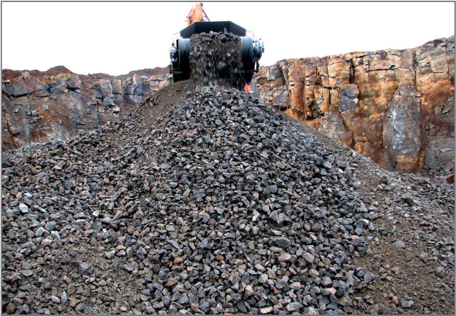
Aðskilnaður undir færiband. Úr grjótnámu, Krísuvíkurheiði við Suðurstrandarveg. (Haf).
