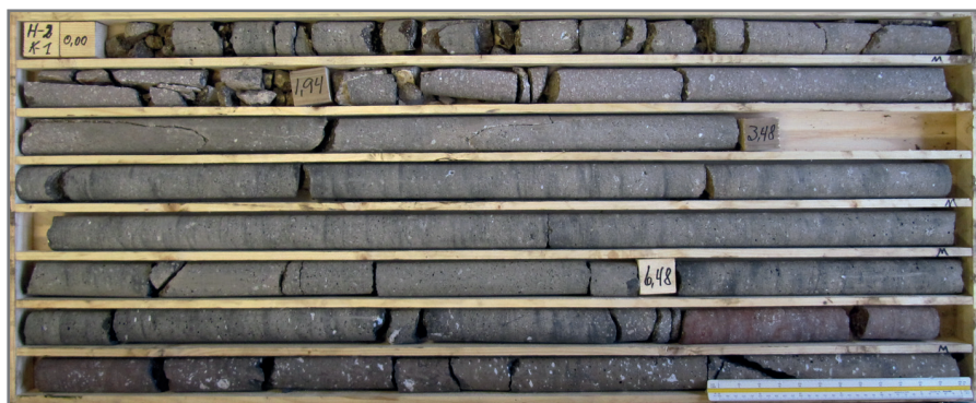
Kjarni úr borun í skeringu á Litlanesi við Kerlingarfjörð. Borkjarnar gefa góðar upplýsingar um efnisgæði í fyrirhugaðri námu. (HBJ).
